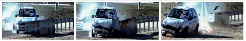
TT 1.3.110 - Frontal, 0°, no eixo - 1500Kg - 110Km/h (EN1317:4,7)
